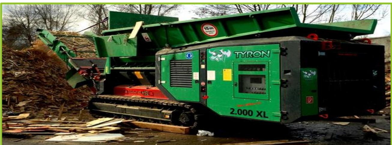
FIGURE 11 TYPICAL SLOW SPEED SHREDDER USED TO MINIMISE WOOD/TIMBER WASTE
